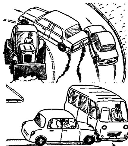
Несмотря на все это, существуют силы, способные вывести автомобиль из подчинения водителю. Они могут вопреки воле водителя направить машину не по заданному им направлению. Одна из этих сил толкает автомобиль в сторону, поворачивает его вокруг вертикальной оси, заставляет колеса скользить вбок. В таких случаях мы говорим о заносе автомобиля. Иногда эта сила даже может опрокинуть автомобиль.
